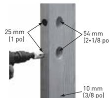
**2b SI VOUS REMPLACEZ UNE POIGNÉE EXISTANTE OU FAITES UNE INSTALLATION SUR UNE PORTE PRÉPERCÉE, VÉRIFIEZ LE MONTANT DE PORTE ET LA PRÉPARATION DE LA PORTE**
