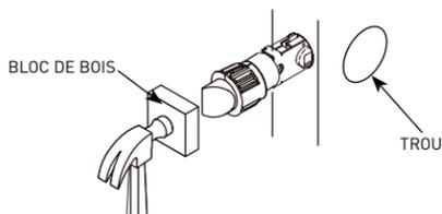
**B. Loquet à têtère :** Fixez le loquet au chant de porte à l'aide des vis pour loquet (BB). S'il n'est pas à ras du chant de porte, marquez le contour de la têtère et ciselez une ouverture de 3 mm (1/8 po) de profondeur, ou jusqu'à ce que la têtère soit à ras du chant de porte.
