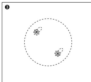
3 Installez les vis de montage de la collerette intermédiaire dans le mur, aux emplacements marqués. Laissez un espace d'environ 3 mm (1/8 po) entre le dessous de la tête de la vis et le mur. Installez la barre d'appui sur le mur en plaçant les extrémités rondes des trous de montage en forme de serrure sur la collerette intermédiaire, par-dessus les vis de montage préinstallées.
