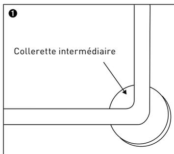
1 Positionnez la barre d'appui sur le mur à l'emplacement souhaité. Utilisez la collerette intermédiaire comme gabarit pour marquer l'emplacement des vis de montage pour la collerette intermédiaire seulement.
