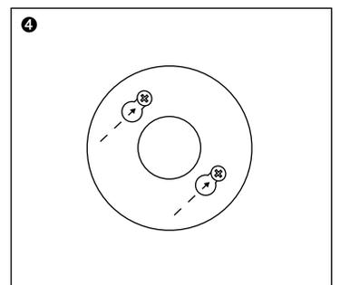
4 Glissez la barre d'appui jusqu'à ce que les vis soient positionnées dans la fente du trou en forme de serrure.
