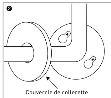
2 Déplacez le couvercle de collerette et marquez l'emplacement des vis au centre des fentes, dans les trous de montage en forme de serrure de la collerette intermédiaire. Retirez la barre d'appui du mur.
